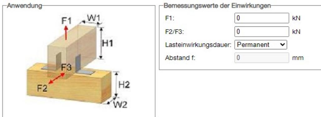
**Anwendung** – Die Anschlussdarstellung wird nur zur Definition der Dimensionen und Lasteinwirkungsrichtungen genutzt. Diese Abbildung ist für jeden Anwendungstyp unterschiedlich
